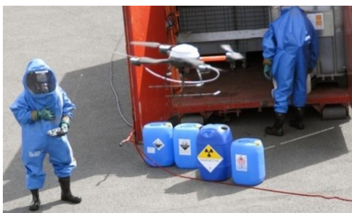
3. ábra Vegyelemzésre és permetezésre tervezett UAV kopterek
