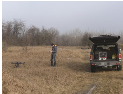
7. ábra A kisebb depóniák és külszíni fejtések felmérése UAV technológiával nagyon gyorsan kivitelezhető.
