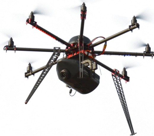
2. ábra Rekreációs és sport célokra használatos, illetve professzionális légi fotogrammetriai felmérésekhez gyártott multirotoros UAV
