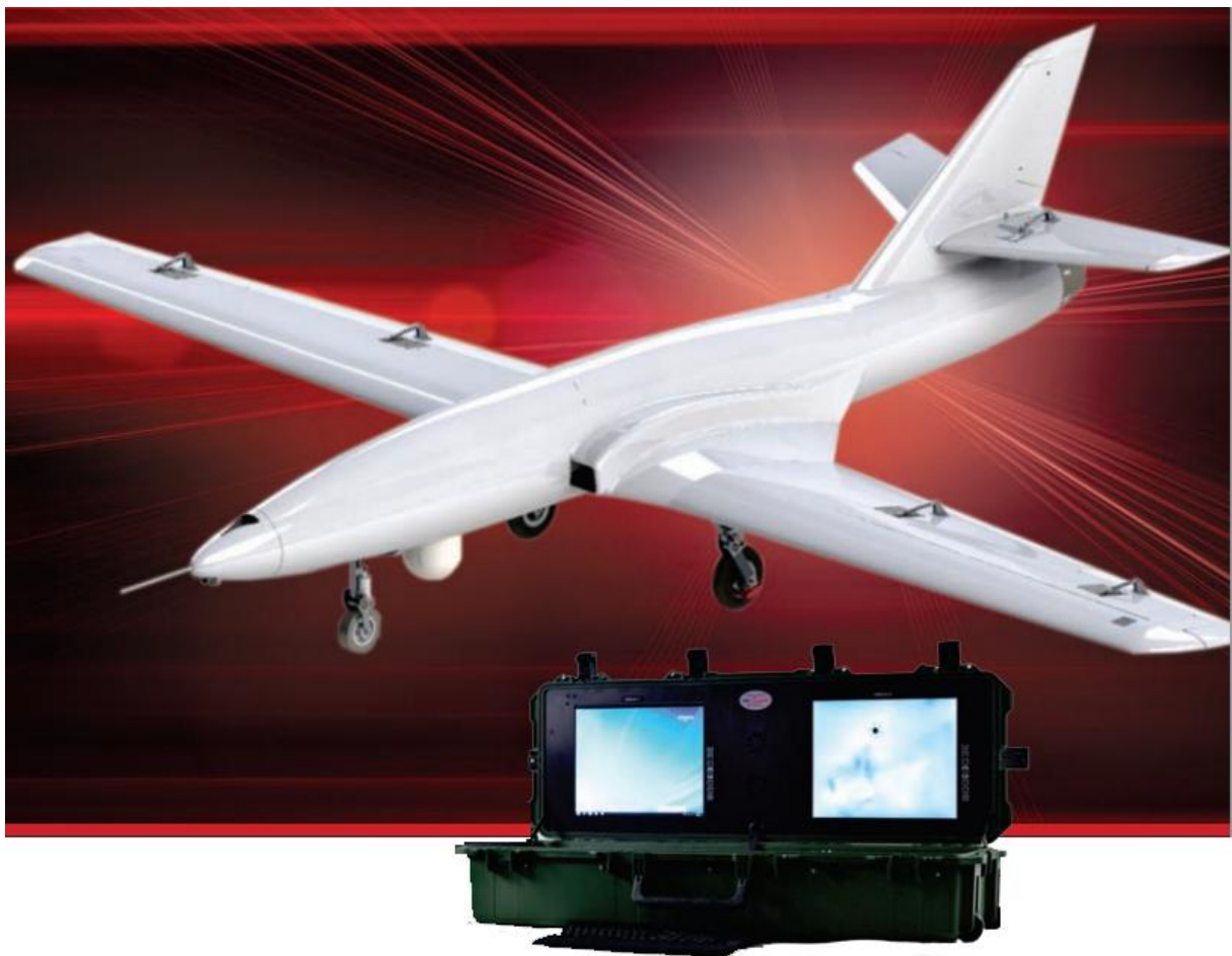
5. ábra Sidewinder merevszárnyú UAV magas légköri vizsgálatokhoz, a hozzá tartozó mobil irányítópulttal
