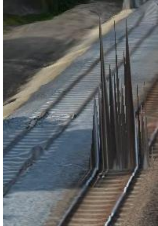
19. ábra Keresztbe futó fémszerkezet és mozgó járművek okozta anomáliák együttese a modellen
