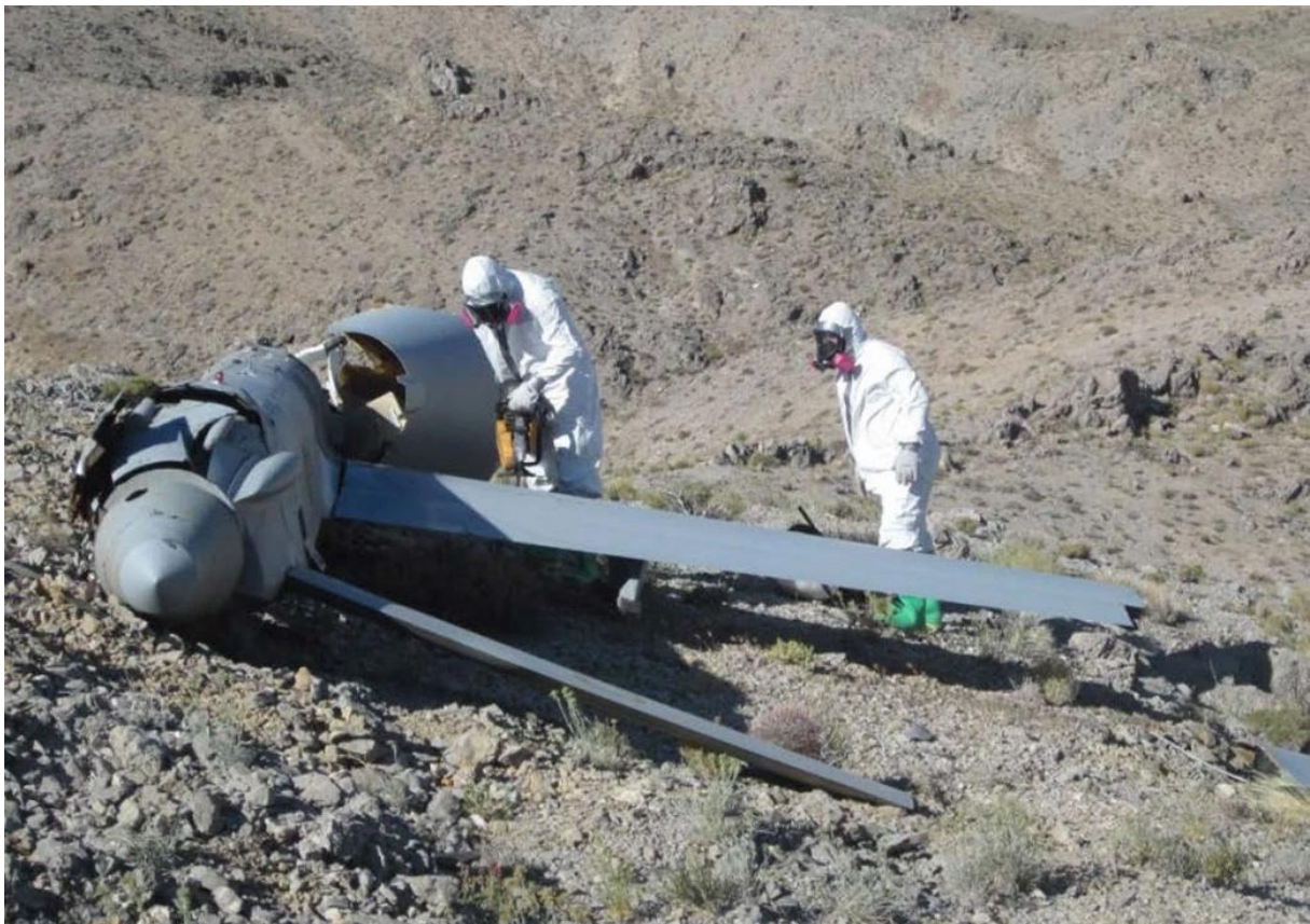
32. ábra Meg kell különböztetni a nagy méretű és a mikrodrón eseteket. A képen látható katonai felderítő eszköz roncsait védőruhában vizsgálják, mert az alacsony észlelhetőségű katonai UAV számos egészségre ártalmas anyagot és bevonatot tartalmaz.
